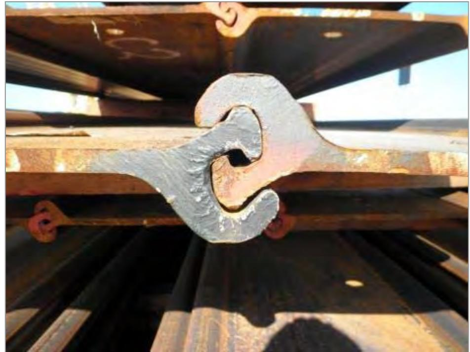
**Interlock Strength IS min. 6000 kN/m**
